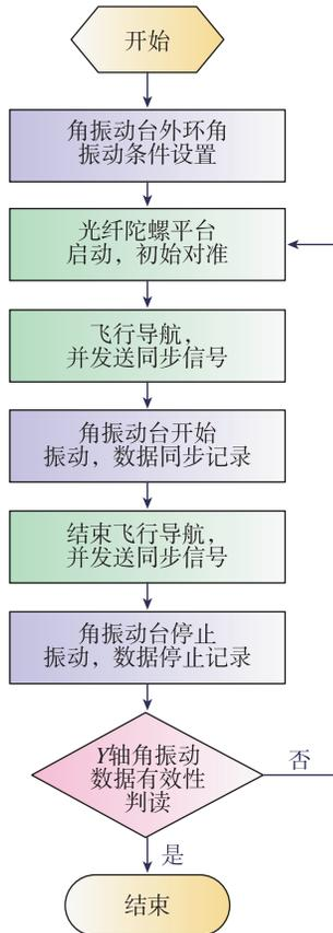
图 4 光纤陀螺平台 Y 轴低频角振动试验流程图
