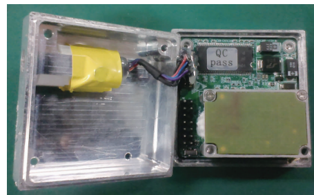
图6 鞋式单兵导航设备的导航模块
