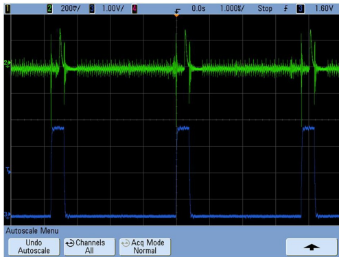
图5 PINFET 输出波形和模拟开关 CLK 信号 Fig. 5 Output signal of PINFET and CLK of analog switch
