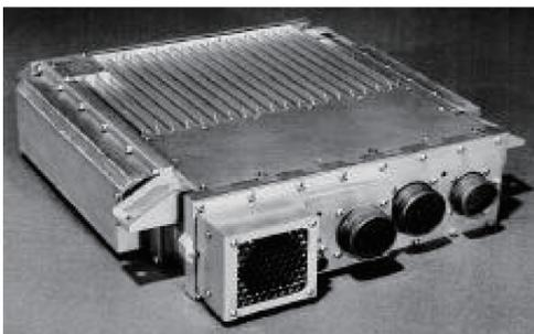
图1 F/A-18B 飞机上试验用电动伺服系统
