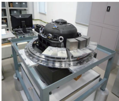
图 12 角位移式引力梯度效应试验现场
