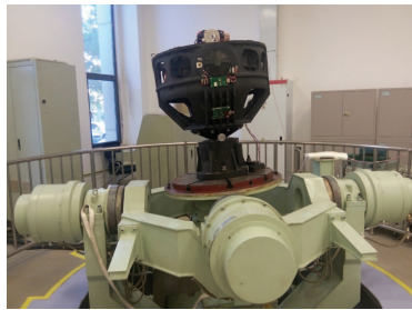
图 16 梯度仪水平摇摆试验现场
