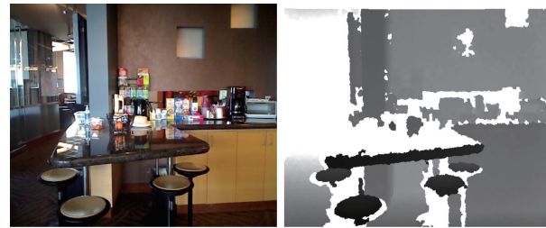
图 2 RGB 图像(左)和 Depth 图像(右) [4]
