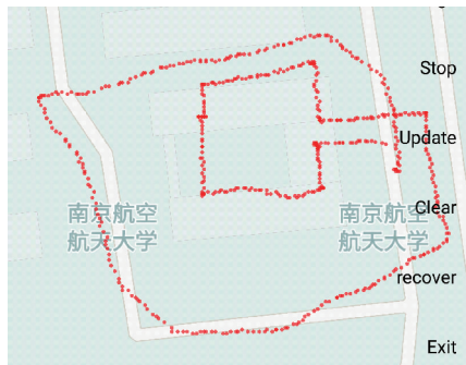
图 8 室内外大范围行走实验数据纯航位推算结果图
