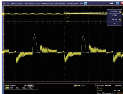
图 9 反电势引起的相电流
