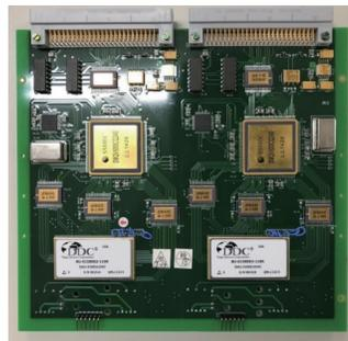
图 6 1553B 总线接口电路
