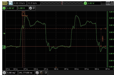
图 8 装配 0\Omega 端接电阻时 ECLKOUT 信号
