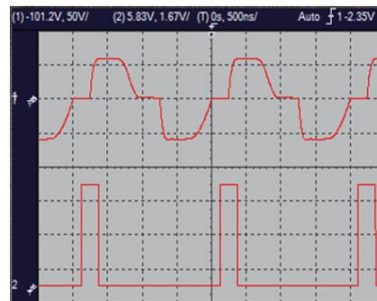
图9 优化前机抖驱动电路小占空比输出波形
