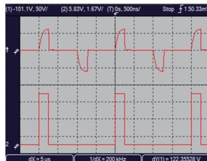
图10 优化后机抖驱动电路小占空比输出波形图
