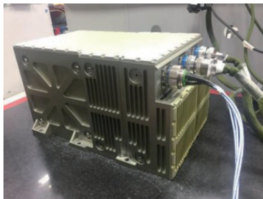
图 3 十二表冗余激光惯导样机
