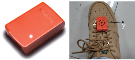
图 4 MEMS 器件及其安装方式
