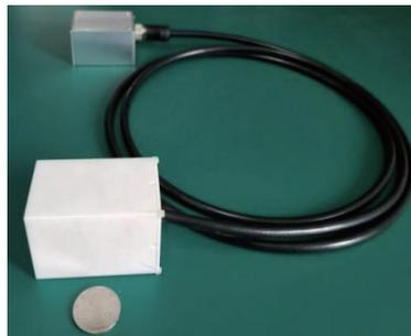
图 13 激光抽运  $M_z$  型原子磁强计样机
