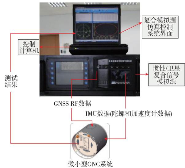
图9 微型GNC系统导航部分测试框图
