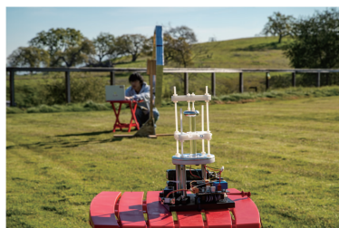
图8 LiNbO 3 机械天线发射器
