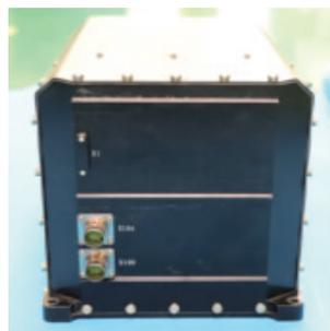
图 5 双通道光纤陀螺捷联惯导样机实物图
