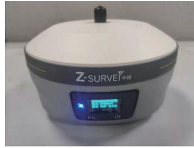
图 3 华测 B5 GNSS 接收机
