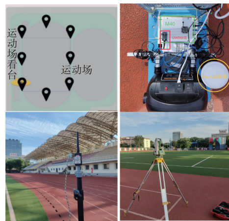
图 2 UWB 定位实验设计与部分实验设备
