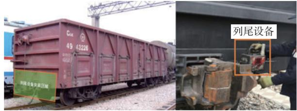
图 3 列尾设备车厢安装位置示意图
