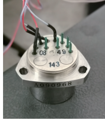
图 2 实验所用的石英挠性加速度计
