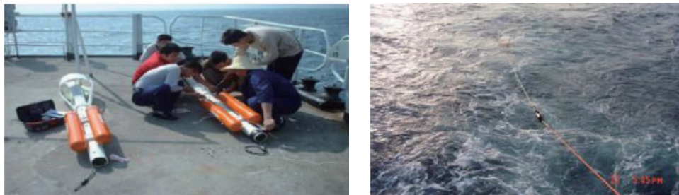
图 2 磁力仪安装及拖曳测量
